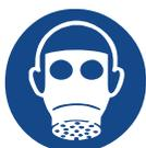
Erforderlich bei Auftreten von Dämpfen/Aerosolen: Filter A.
